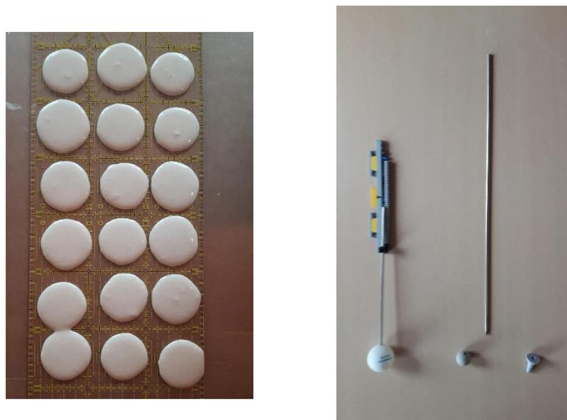
Abbildung 9: a) Teigflecken mit Kegel auf fester Platte b) Speiserverschlüsse
