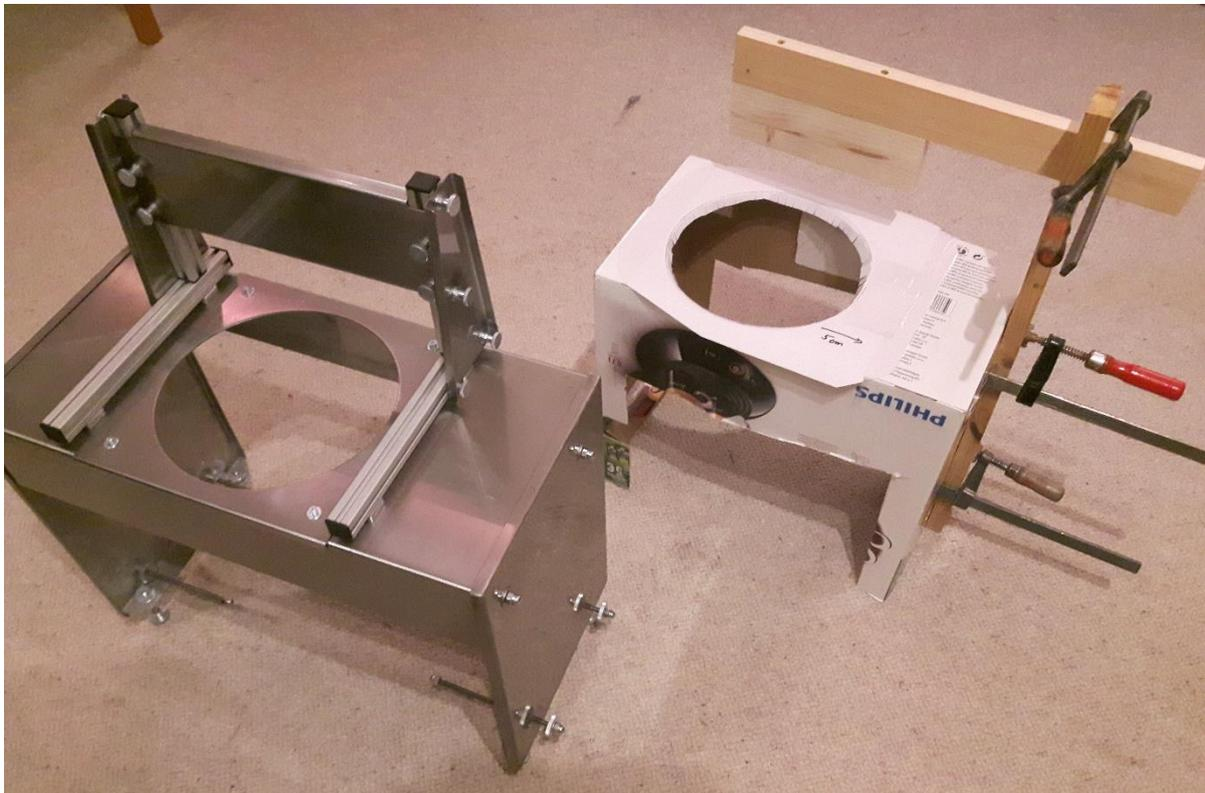
Das ganze Gestell steht auf vier höhenverstellbaren Schraubfüßen, um den Abstand zwischen Trichteröffnung und Dosierplatte einstellen zu können. Außerdem habe ich, um die Metallschale mit dem XY-Tisch genau unter die Trichteröffnung zu bringen, vier Justierschrauben an den Seiten angebracht.
